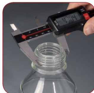
Gewindemessung an einer Flasche
