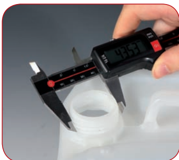
Gewindemessung an einem Kanister
