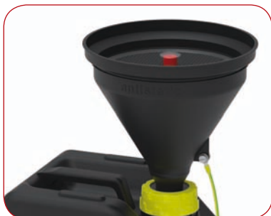
b.safe Trichter 180 mit Füllstandskontrolle (Artikelnr. R 840-16) Optische Füllstandskontrolle, die fest im Trichter eingebaut ist. Sobald die rote Anzeige das Schauglas komplett ausfüllt, ist der Behälter zu tauschen.
