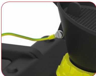
Erdungskabel (Artikelnr. R 612-01) mit zweimal Ringkabelschuh mit Schraube, Mutter und Unterlegscheibe zur Verbindung an Erde mittels z. B. Erdungsglasche wie an b.safe Trichtern.
